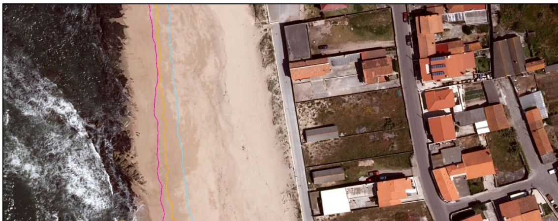
Figura 17. Ejemplo de la línea de costa extraída del MDT obtenido con LiDAR (rosa) y de los MDE obtenidos a partir de fotografías aéreas obtenidas con avión en 2017 (azul) y 2018 (naranja).
